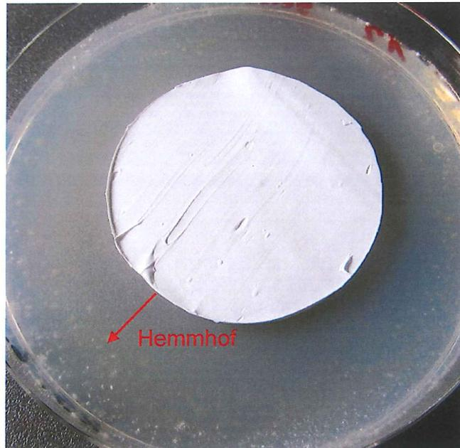
Foto 1: Untersuchungsmaterial **SILIRUB Cleanroom, CH 200054801, Farbe weiß** nach einer Inkubationszeit von 28 Tagen ohne sichtbaren Pilzbewuchs mit Hemmhof
