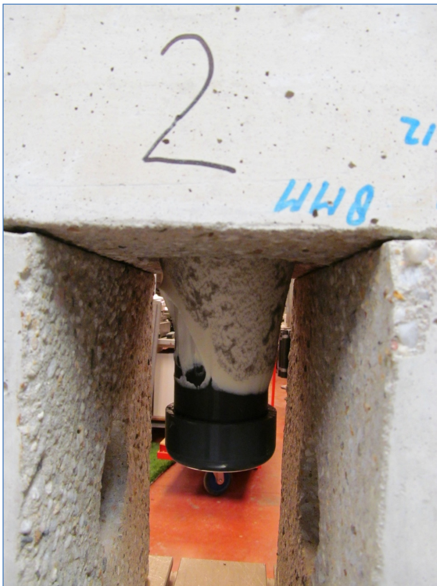
Aanzicht bepaling uittreksterkte
